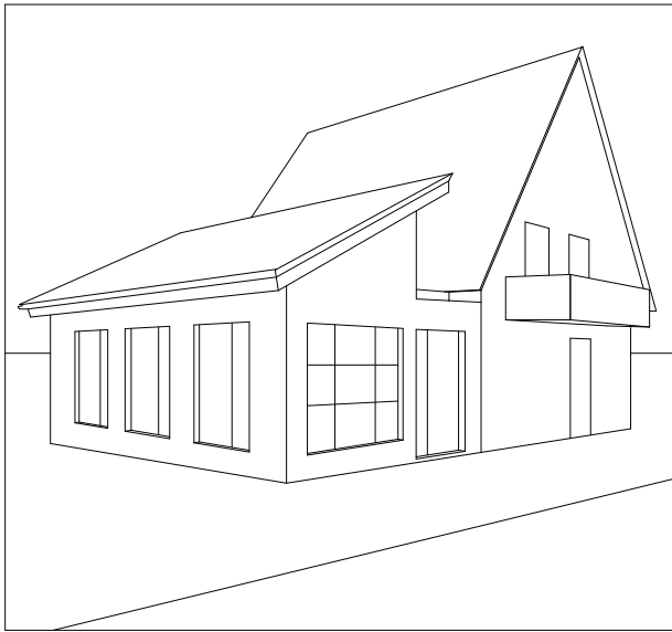
Anbau zu eigenständig Anbau fügt sich nicht dem Hauptgebäude an
