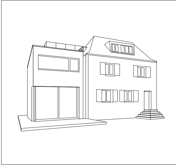
Anbau zu hoch Anbau zu gleichgewichtig, Wirkung wie Doppelhaus
